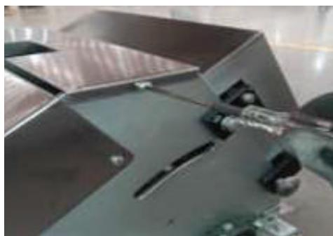
**I** Atornillar los tornillos de guarda con resaque.
